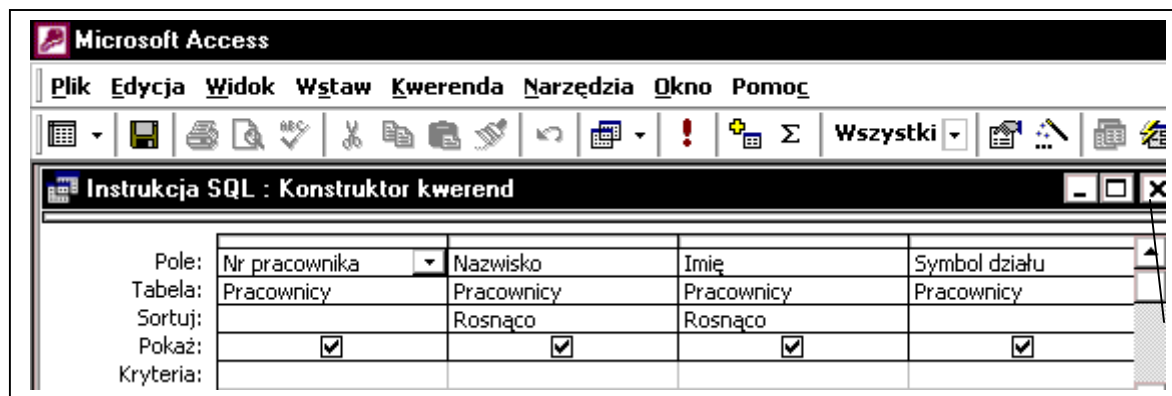
Rys. 8 Konstruktor kwerend – kwerenda wybiera pola z tabeli Pracownicy i sortuje.
