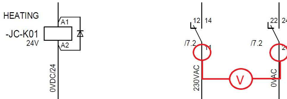
Rysunek 40. Pomiar napięcia na stykach przekaźnika JC-K01
