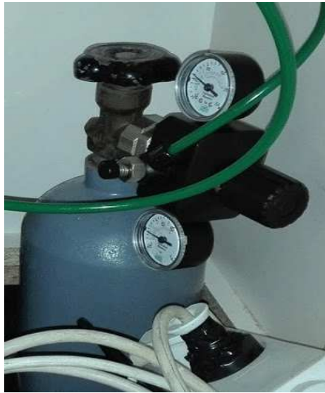
Rys. 2.3. butla z CO 2 wyposażona w reduktor i elektrozawór
