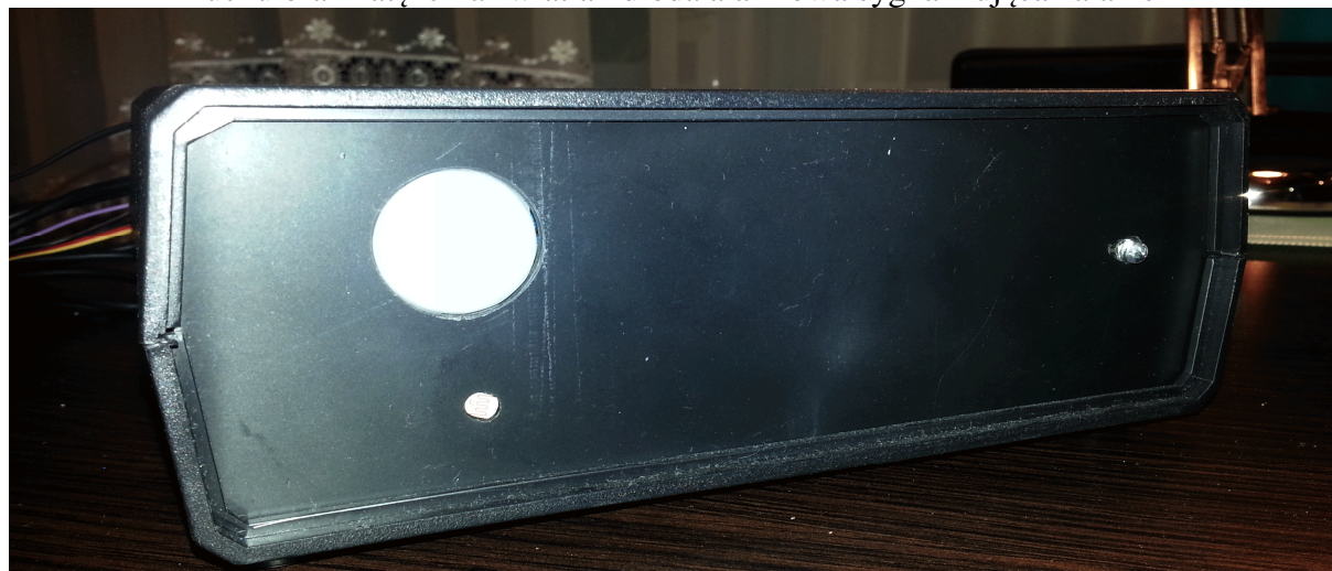
Rys. 7.1. fotografia przedstawiająca sterownik od strony przedniej, gdzie znajduje się czujnik ruchu oraz natężenia światła i dioda alarmowa sygnalizująca zalanie
