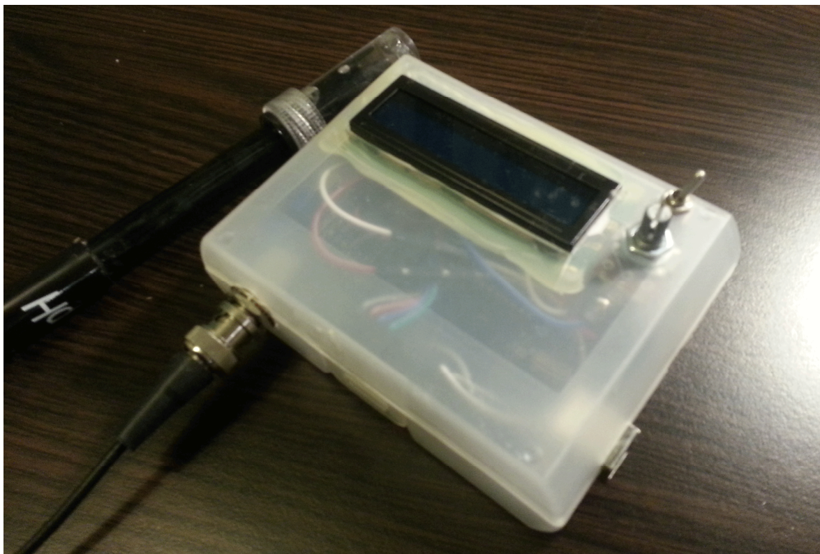
Rys. 7.3 fotografia przedstawiająca moduł sterownika mierzący poziom PH
